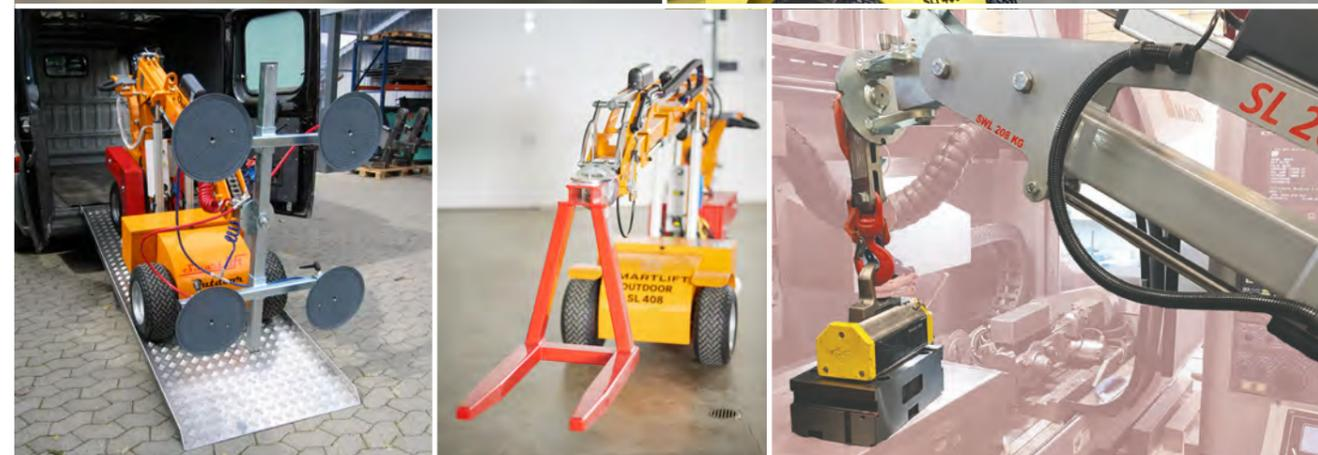
Ein robuster und selbstfahrender Transportwagen mit einem elektrischen Heber, der bis zu 86 cm über dem Boden hebt. Der Wagen hat zwei Seitentaschen, um von einem Gabelstapler angehoben zu werden.
